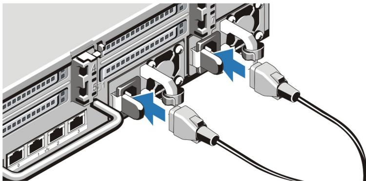
図 3. 電源ケーブルの接続
